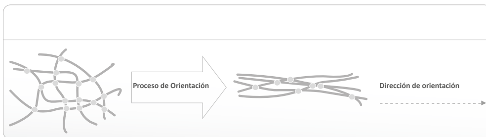
El proceso de Orientación Molecular modifica la estructura del PVC al ordenar en línea las moléculas del polímero.
