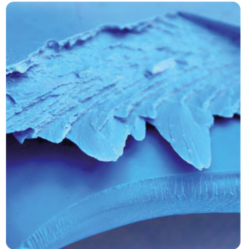
Cuando el PVC de estructura amorfa (sección inferior) se somete al proceso de orientación, se obtiene una estructura laminar (sección superior).
