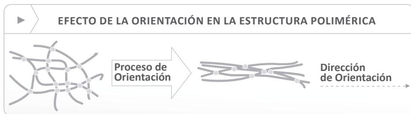
El proceso de Orientación Molecular modifica la estructura del PVC al ordenar en línea las moléculas del polímero.
