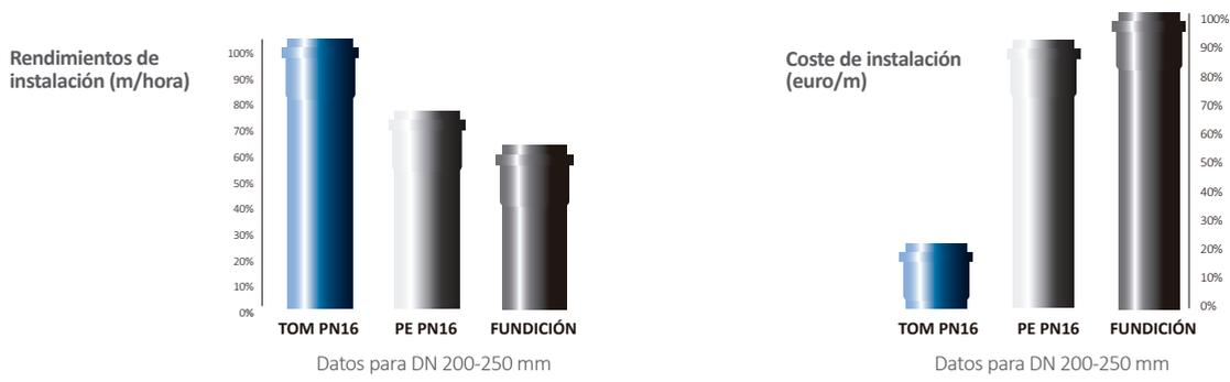
La gran resistencia de los caños TOM® hace que la manipulación pueda realizarse con **mayores rendimientos de descarga, colocación en zanja y conexión entre caños**. Además, la facilidad de conexión de los caños entre sí, proporciona unos rendimientos muy elevados: puede ocuparse de ello personal de menor cualificación y sin ayuda de maquinaria hasta el DN315 mm.
