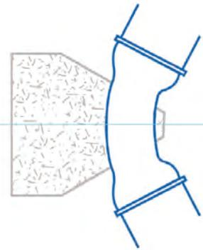
Es importante que el hormigón se vierta directamente contra el terreno ya posicionado, y tenga una resistencia mecánica suficiente. En el momento de diseñar los anclajes, no se debe olvidar que **las juntas deben estar libres**, con el fin de permitir su posterior inspección durante las pruebas hidráulicas.
